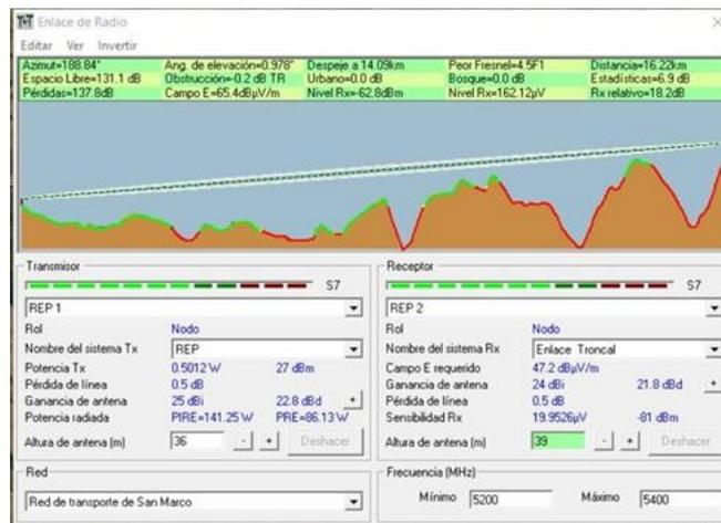
Fig. 4. Perfil de enlace de radio entre Repetidor 1 y Repetidor 2.
